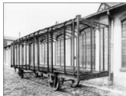
Ocelová kostra motorového vozu M132.001 z roku 1927
