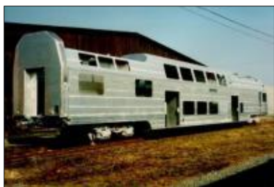
Hrubá stavba vozové skříň motorového vozu elektrické jednotky řady 471
