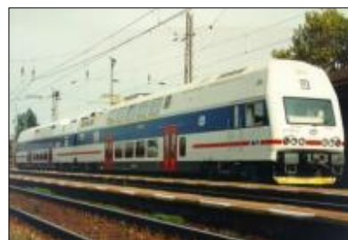
Prototypová elektrická jednotka řady 471 ve složení motorový a řídicí vůz
