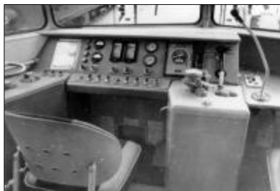
Stanoviště strojvedoucího – řídicí pult EMJ 475.1
